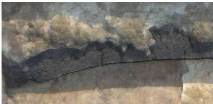
รูปที่ 2.2-3 การเกิดรอยร้าวที่ผิวของแผ่นยางเนื่องมาจากอิทธิพลของโอโซน
