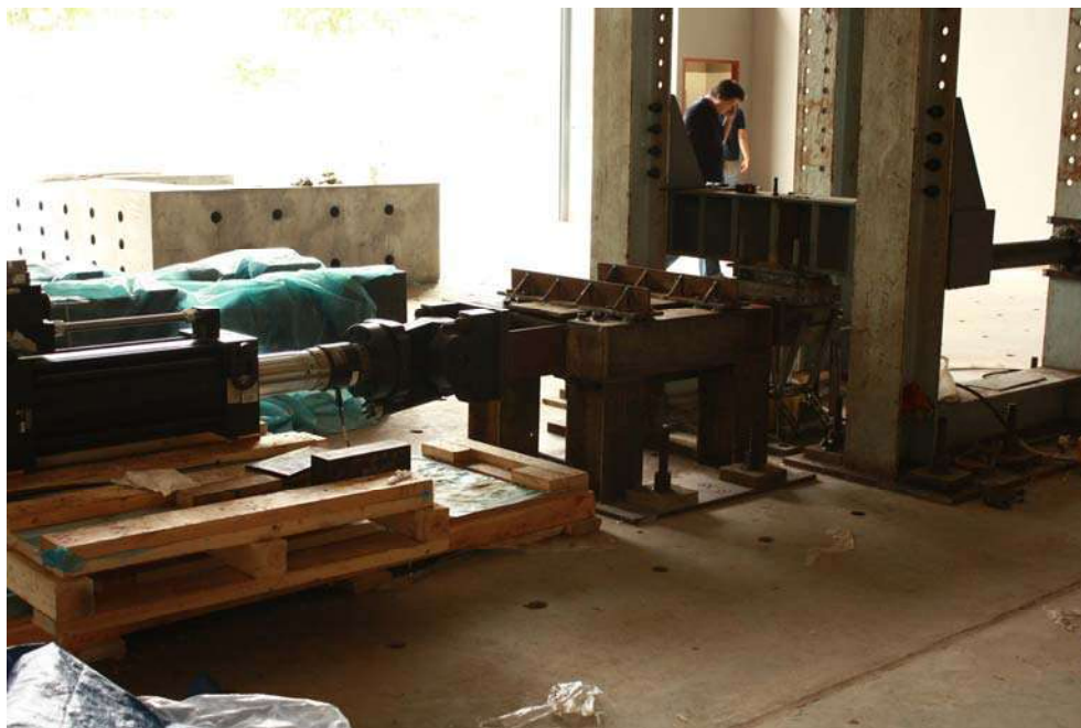
รูปที่ 4.2-5 ชุดเครื่องมือที่ใช้ในการทดสอบการประยุกต์แรงเฉือนให้กับแผ่นยางรองคอสสะพาน
