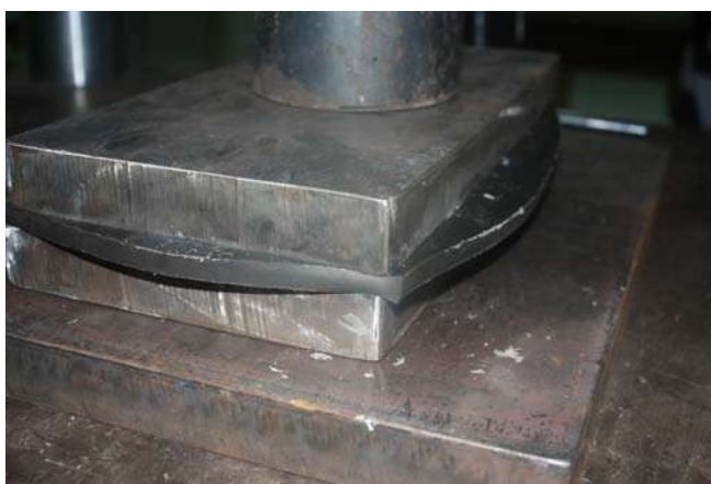
รูปที่ 3.3-2 การทดสอบ Compression Test ของแผ่นยางรองคอสพานประเภทยางล้วน (ชนิดยางธรรมชาติ) ของ บจก.วัฒนาสุข
