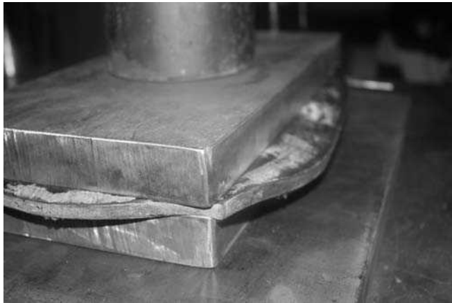
รูปที่ 3.3-3 การทดสอบ Compression Test ของแผ่นยางรองคอสพานประเภทยางล้วน (ชนิดยางธรรมชาติ) ของ บจก.พีซีพี เอ็นจิเนียริง
