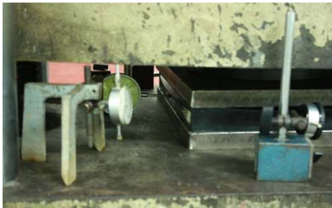
รูปที่ 3.3-13 การทดสอบ Compression Test ของแผ่นยางรองคอสสะพานประเภท เสริมกำลังด้วยแผ่นเหล็ก(ชนิดยางธรรมชาติ) ของ บ. Cakra Ulung
