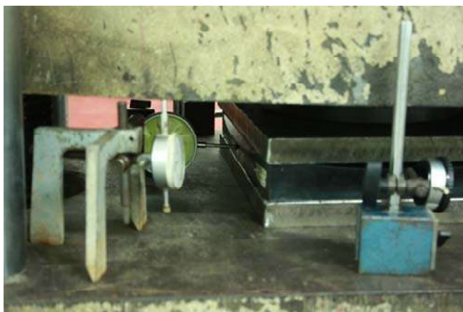
รูปที่ 3.3-11 การทดสอบ Compression Test ของแผ่นยางรองคอสสะพานประเภท เสริมกำลังด้วยแผ่นเหล็ก(ชนิดยางธรรมชาติ) ของ บจก.พีซีพี เอ็นจิเนียริง
