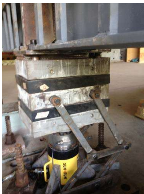
รูปที่ 4.2-4 ชุดควบคุมระนาบแรงเฉือน (arm link)
