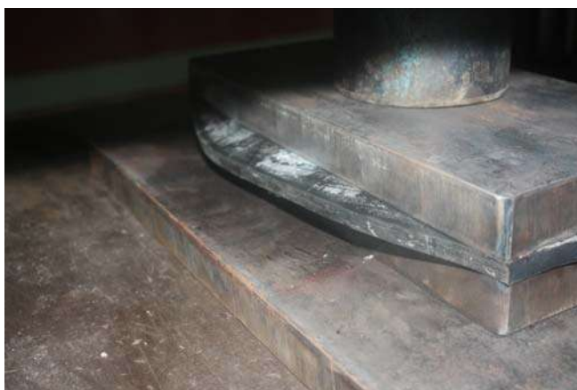
รูปที่ 3.3-1 การทดสอบ Compression Test ของแผ่นยางรองคอสพานประเภทยางล้วน (ชนิดยางธรรมชาติ) ของ บจก.วัฒนาสุข
