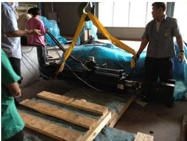
รูปที่ 4.2-1 เครื่อง hydraulic Actuator ขนาด 500 kN ที่ใช้ทดสอบ shear fatigue test
