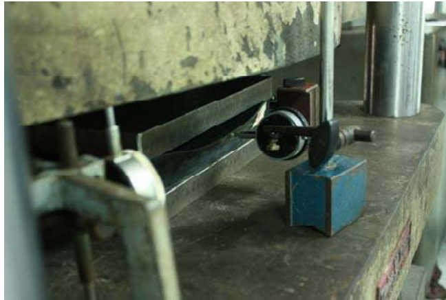
รูปที่ 3.3-12 การทดสอบ Compression Test ของแผ่นยางรองคอสสะพานประเภท เสริมกำลังด้วยแผ่นเหล็ก(ชนิดยางสังเคราะห์) ของ บจก.พีซีพี เอ็นจิเนียริง
