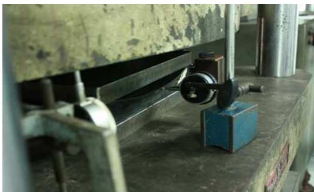
รูปที่ 3.3-14 การทดสอบ Compression Test ของแผ่นยางรองคอสสะพานประเภท เสริมกำลังด้วยแผ่นเหล็ก(ชนิดยางสังเคราะห์) ของ บ. Cakra Ulung
