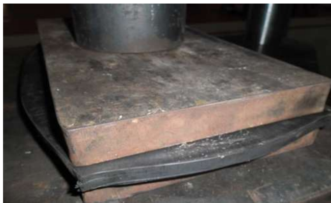
รูปที่ 3.3-5 การทดสอบ Compression Test ของแผ่นยางรองคอสพานประเภทยางล้วน (ชนิดยางธรรมชาติ) ของ บ. Cakra Ulung
