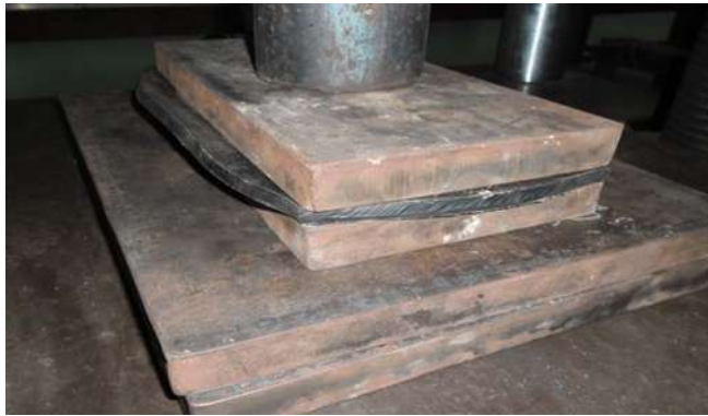
รูปที่ 3.3-6 การทดสอบ Compression Test ของแผ่นยางรองคอสพานประเภทยางล้วน (ชนิดยางธรรมชาติ) ของ บ. Cakra Ulung
