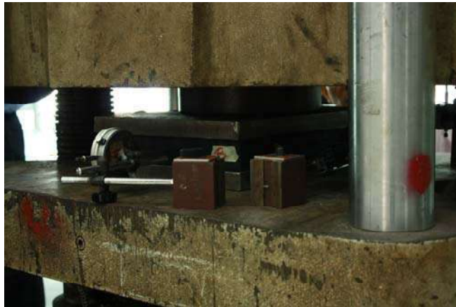
รูปที่ 3.3-9 การทดสอบ Compression Test ของแผ่นยางรองคอสสะพานประเภท เสริมกำลังด้วยแผ่นเหล็ก(ชนิดยางธรรมชาติ) ของ บจก.วัฒนาสุข
