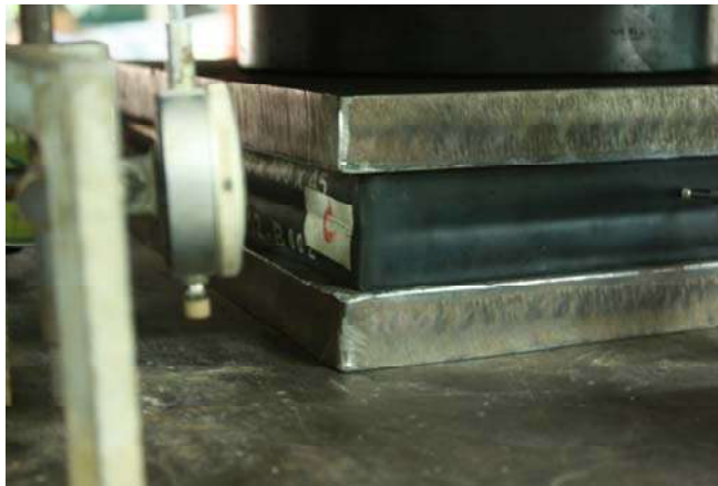
รูปที่ 3.3-10 การทดสอบ Compression Test ของแผ่นยางรองคอสสะพานประเภท เสริมกำลังด้วยแผ่นเหล็ก(ชนิดยางสังเคราะห์) ของ บจก.วัฒนาสุข
