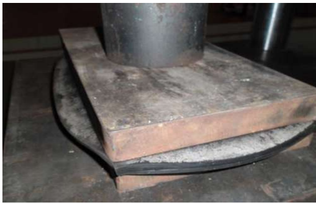
รูปที่ 3.3-7 การทดสอบ Compression Test ของแผ่นยางรองคอสพานประเภทยางล้วน (ชนิดยางธรรมชาติ) ของ บ. Jiangsu Pacific Rubber
