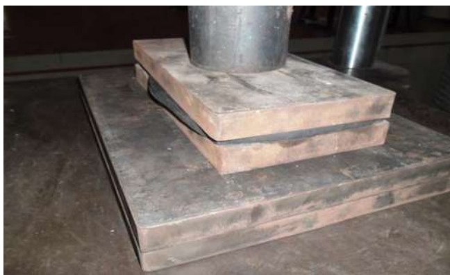
รูปที่ 3.3-8 การทดสอบ Compression Test ของแผ่นยางรองคอสพานประเภทยางล้วน (ชนิดยางสังเคราะห์) ของ บ. Jiangsu Pacific Rubber
